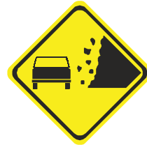
A - 27 ÁREA COM DESMORONAMENTO
